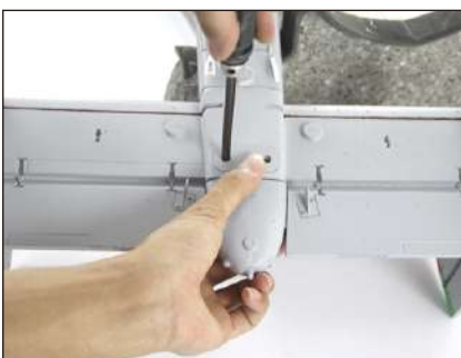
将垂尾舵机与机身内置的舵机延长线连接起来
